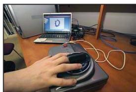
РИСУНОК 1 – Внешний вид прибора газоразрядной визуализации
